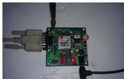
Fig.9. GSM Module
