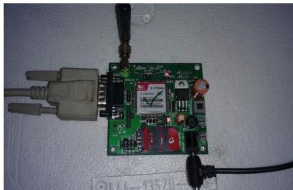
Fig.8. GSM Module
