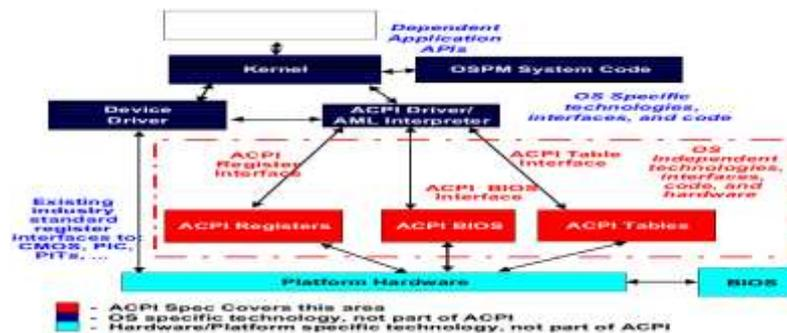
Fig 5.1 ACPI/OSPM Subsystem
